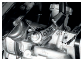
Posición "ON" del choke
