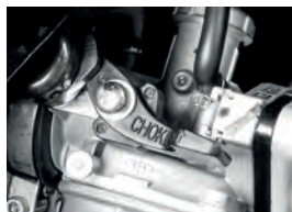
Posición "OFF" del choke
