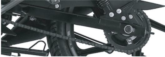
El ajuste de la cadena debe ser realizado siempre que sea requerido (realice constantemente la inspección de esta). La holgura de la cadena debe estar entre 25 - 30 mm. Las marcas de los ajustadores de la cadena deben estar en la misma posición a ambos lados.
