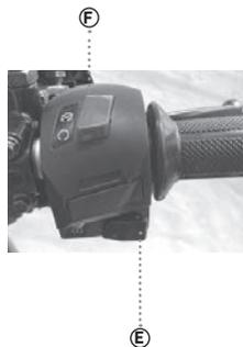
**E. Interruptor de Arranque:** el botón de arranque acciona el arranque eléctrico.
