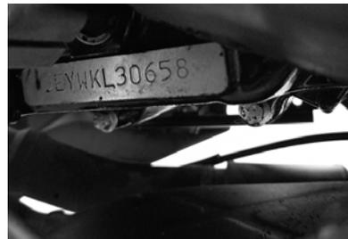
El número de Motor se ubica en la parte inferior del motor del lado izquierdo, justo debajo de la palanca de cambios.
